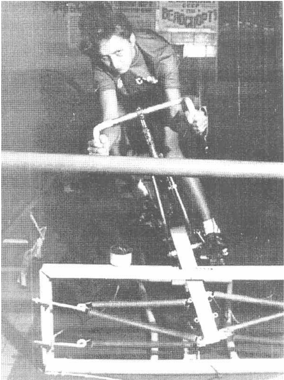
Рис. 80. Имитация прохождения виража на «горном тренажере». Корпус гонцицы наклонен под одним углом с велосипедом. При правильном наклоне велосипеда и точно выбранной скорости гонщик сможет удержаться на вираже
