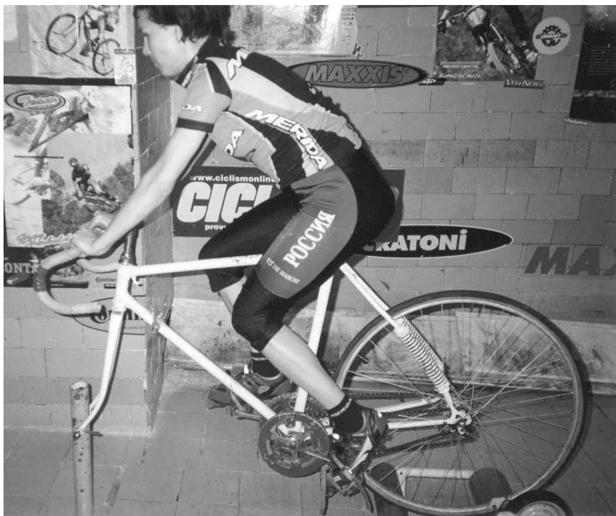
Рис. 73. На 3-4-й день тренировки на этом тренажере гонщик высокого класса перестает замечать, что каждый шатун имеет свою ось и независимую цепную передачу, тем самым совершенствует технику кругового рационального педалирования
