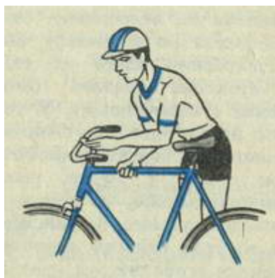
Рис. 13. Проверка правильности установки седла по высоте и длине. Рис. 14. Положение стопы на педали
